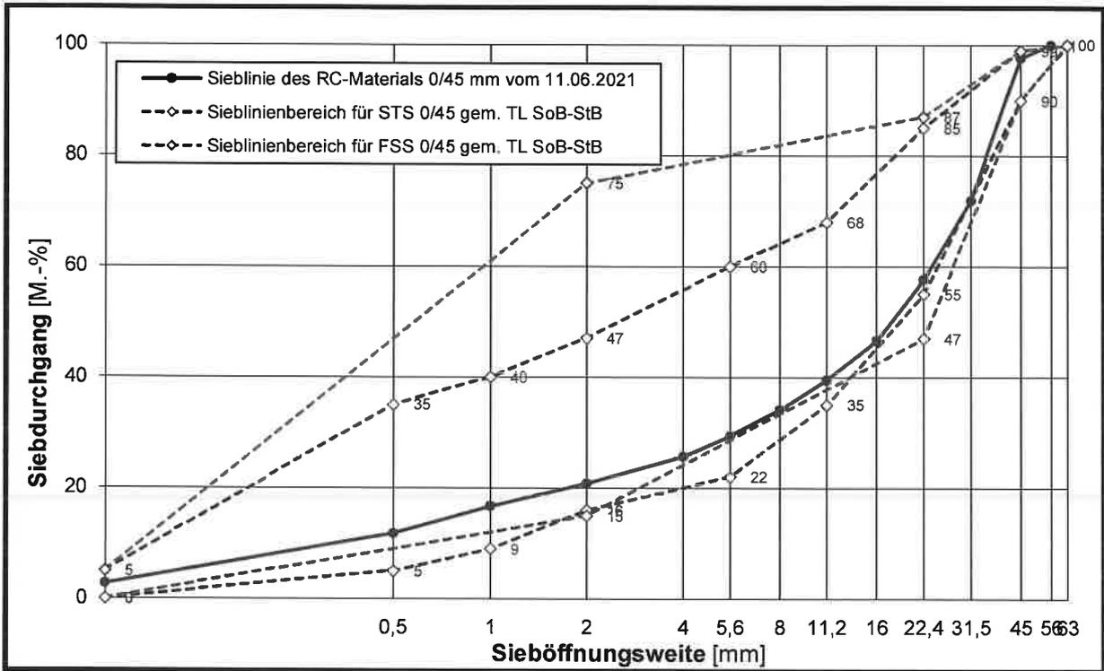
Korngrößenverteilung des untersuchten RC-Materials 0/45 mm mit Sieblinienbereich für Schottertrag- und Frostschuttschichten 0/45 mm gemäß TL SoB-StB 7/
